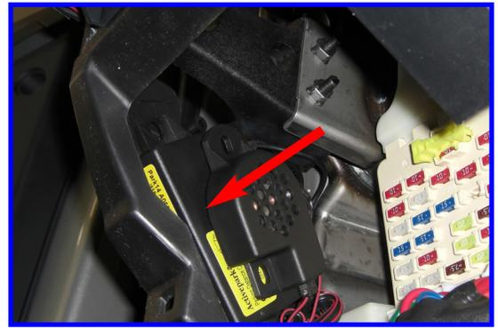
**SEGNALATORE ACUSTICO:** Posizionare il buzzer all'interno dell'abitacolo sulla parte piana inferiore del portaoggetti situato alla sinistra del volante. Per il fissaggio, utilizzare il velcro in dotazione.
