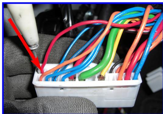
**POSITIVO SOTTOCHIAVE:** Per il collegamento elettrico individuare il filo ROSSO pos.2 nel connettore IP/A BIANCO a 18 poli nella parte frontale della centralina fusibili body computer, ubicata dietro la paratia in plastica sinistra, sotto al volante.
