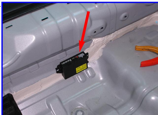
**SEGNALATORE ACUSTICO** : Fissare il segnalatore acustico (buzzer) sul fianco baule lato guida.
